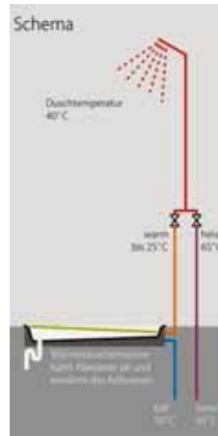
Schematische Darstellung der Funktionsweise der «Jouliä»-Dusche. Bild: zvg
