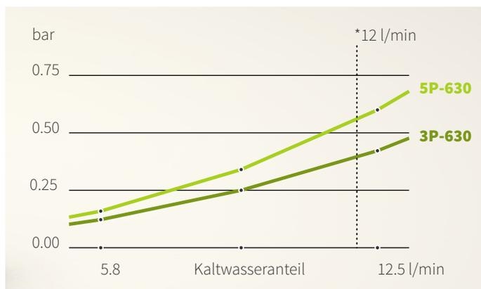
\*Gemäss W3d Richtlinie des SVGW wird der Druckverlust im Wärmetauscher bei 12 l/min bestimmt.
